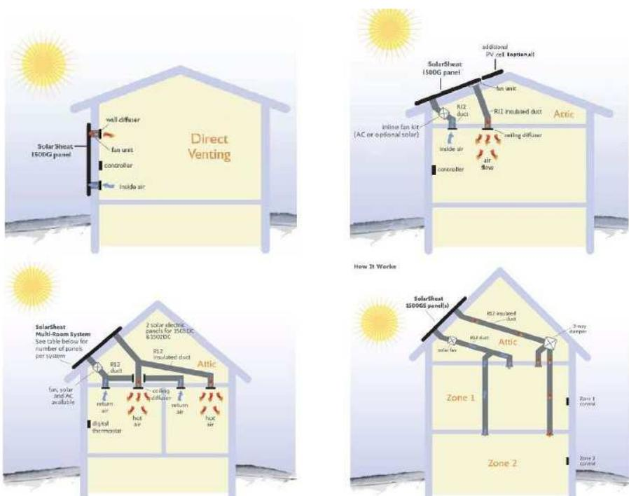
Dimensioniert man die Kollektorfläche etwas größer, kann mit dem SolarSheat - Luftkollektor die bestehende Heizung unterstützt werden. Bei ausreichender Sonneneinstrahlung werden so konventionelle Energieträger wie Heizöl oder Erdgas durch die Sonnenenergie ersetzt.
